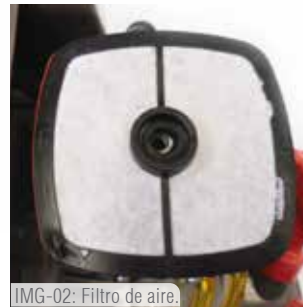
IMG-02: Filtro de aire.
