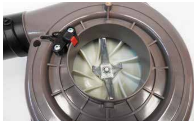
IMG-06: Switch de seguridad que impide puesta en marcha accidental y cuchilla de triturado.
